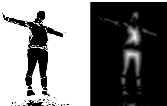
Obrázok 4.25: Príklad vzdialenostnej transformácie s Euklidovou metrikou. Vľavo je vstupný obraz, vpravo je výstupný obraz.
