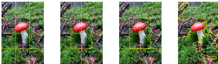
Obrázok 5.1: Príklad segmentácie obrazu. Zľava pravidelná segmentácia bez prekryvu, pravidelná segmentácia s prekryvom v strede, nepravidelná segmentácia s prekryvom v strede a segmentácia podľa obsahu obrazu.
