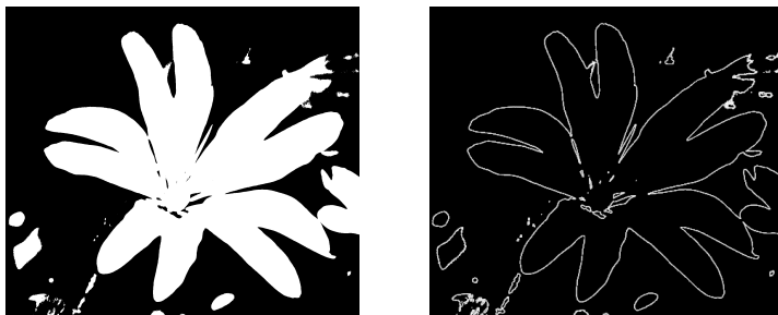
Obrázok 4.16: Príklad binárneho morfológického gradientu. Vľavo je vstupný obraz, vpravo je výstupný obraz.
