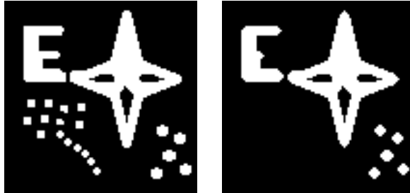
Obrázok 4.8: Príklad morfológického otvorenia. Vľavo je vstupný obraz, vpravo je výstupný obraz. (Použitý bol štruktúrny element znázornený na obrázku 4.4).
