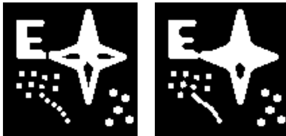
Obrázok 4.9: Príklad morfológického uzavretia. Vľavo je vstupný obraz, vpravo je výstupný obraz. (Použitý bol štruktúrny element znázornený na obrázku 4.4).
