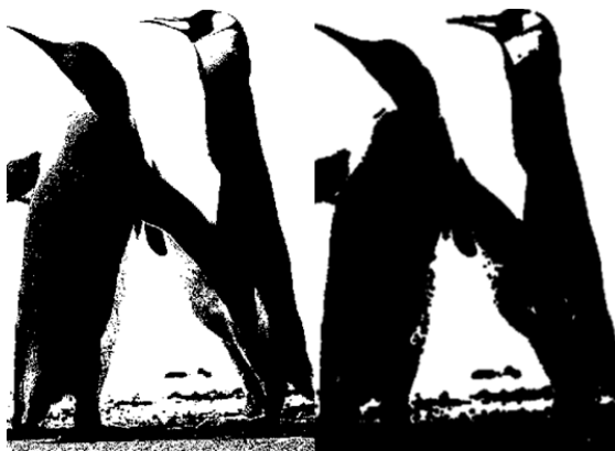
Obrázok 4.7: Vľavo je binárny vstupný obraz, vpravo je erodovaný obraz. Môžeme si všimnúť, že malé biele detaily zo vstupného obrazu erodovaním zmizli na úkor čiernych oblastí.
