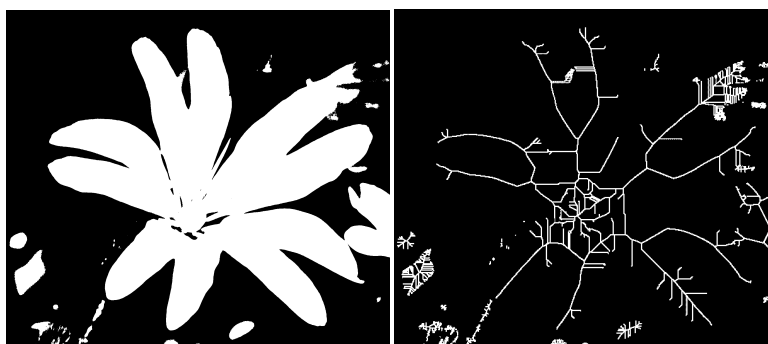
Obrázok 4.26: Príklad výpočtu kostry (skeleton). Vľavo je vstupný binárny obraz, vpravo je obraz kostry.
