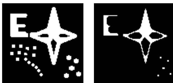
Obrázok 4.6: Vľavo je binárny vstupný obraz, vpravo je erodovaný výstupný obraz. (Použitý bol štrukturálny element je znázornený na obrázku 4.4).
