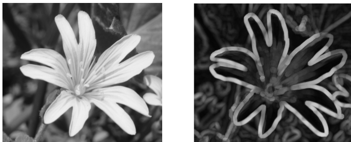
Obrázok 4.17: Príklad šedotónového morfológického gradientu. Vľavo je vstupný obraz, vpravo je výstupný obraz.
