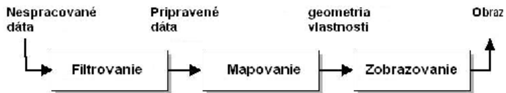
obrázok 2.1: Proces zobrazovania objemových dát (visualization pipeline).
