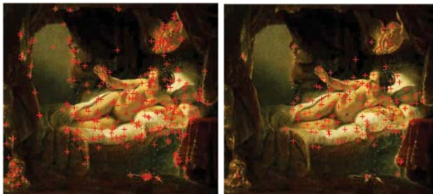
(a) Body detekované pomocou SIFTu (b) Body detekované pomocou SURFu
