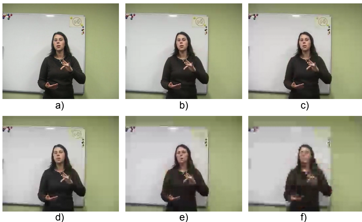
Obr. 5.3: Snímka č. 210 videosekvencie: a) Pôvodná kvalitaô snímky dekódované pomocou H.264 s rôznou kvalitou b) QP = 30 c) QP = 35 d) QP = 40 e) QP = 45 f) QP = 50
