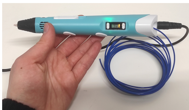
Obr. 6: 3D pero so zasunutým filamentom pripravené na tvorbu.
