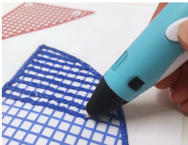
Obr. 8: Tvorba podstavy kužeľa pomocou pripravenej šablóny.
